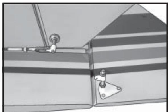
**RUDDER PULL - PULL CABLE SYSTEM.**
