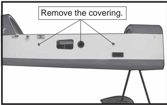
**INSTALLING THE BATTERY-RECEIVER.**
